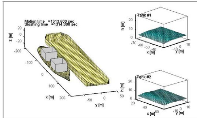
**FIG. 5. SNAPSHOT OF MOTION-SLOSHING TIME DOMAIN ANIMATION.**
